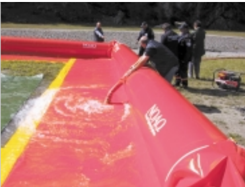
L'acqua viene pompata contro la barriera
